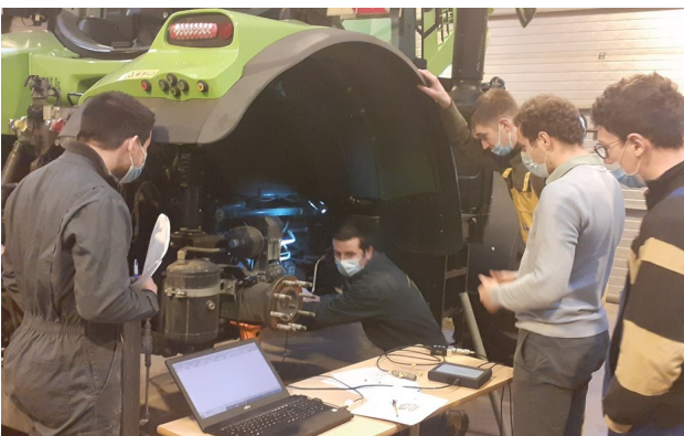
Pose d'un manomètre pour mesurer la pression de l'huile dans une ligne LS. © Damien Calais.
