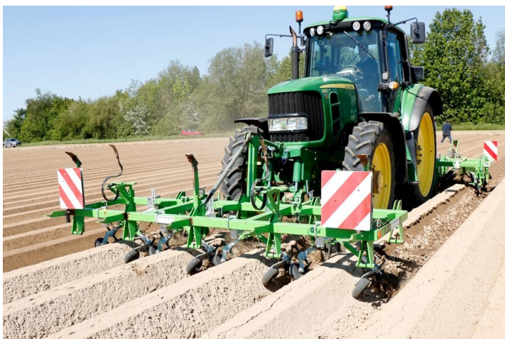
Figure 1 : Bineuse et butoir à disque en action lors d'un chantier de désherbage de pommes de terre © Arvalis
