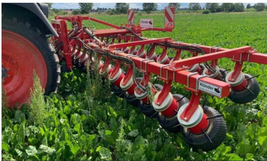
Le nouvel outil de désherbage mécanique, la désherbeuse à pneus © Bordeau P, 2021
