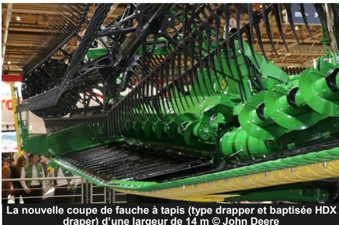
La nouvelle coupe de fauche à tapis (type drapper et baptisée HDX draper) d'une largeur de 14 m © John Deere
