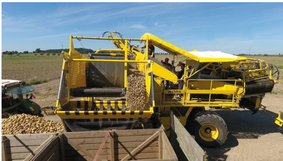
Arracheuse Ropa Keiler 2 à double trémie de séparation des calibres © Ropa, 2020
