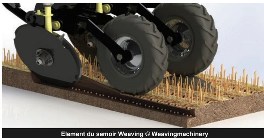
Cette disposition technique permet ainsi de limiter la résistance du semoir qui pénètre plus facilement dans le sol sans demander une puissance de traction trop importante. Les données constructeurs nous donnent un rapport de 40 chevaux par mètre. De plus, la qualité d'implantation de la culture est préservée. En effet, l'inclinaison permet de conserver un sillon propre sans résidus tout en limitant le bouleversement du sol et la levée d'adventices.
