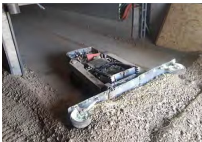
Robot de nettoyage des bâtiments de stockage développé par MLV Innovation et Agri © MLV Innovation et Agri
