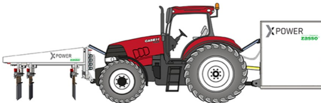
Structure du système XPower (Zasso/Case IH)
