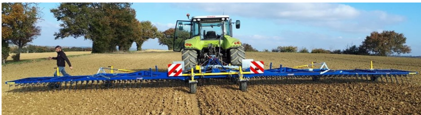
Une herse étrille avec réglage automatique de l'agressivité
