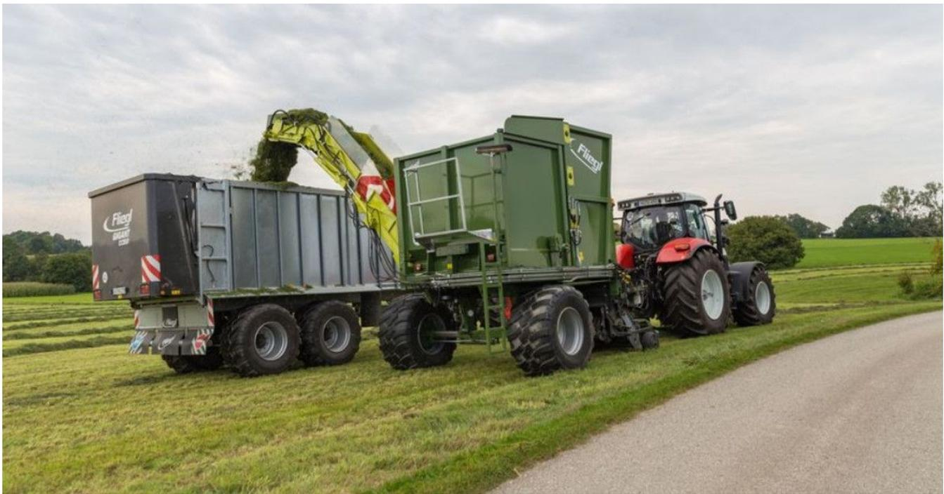
La Fliegl Büffel est un hybride entre une benne autochargeuse et une ensileuse automotrice d'herbe
