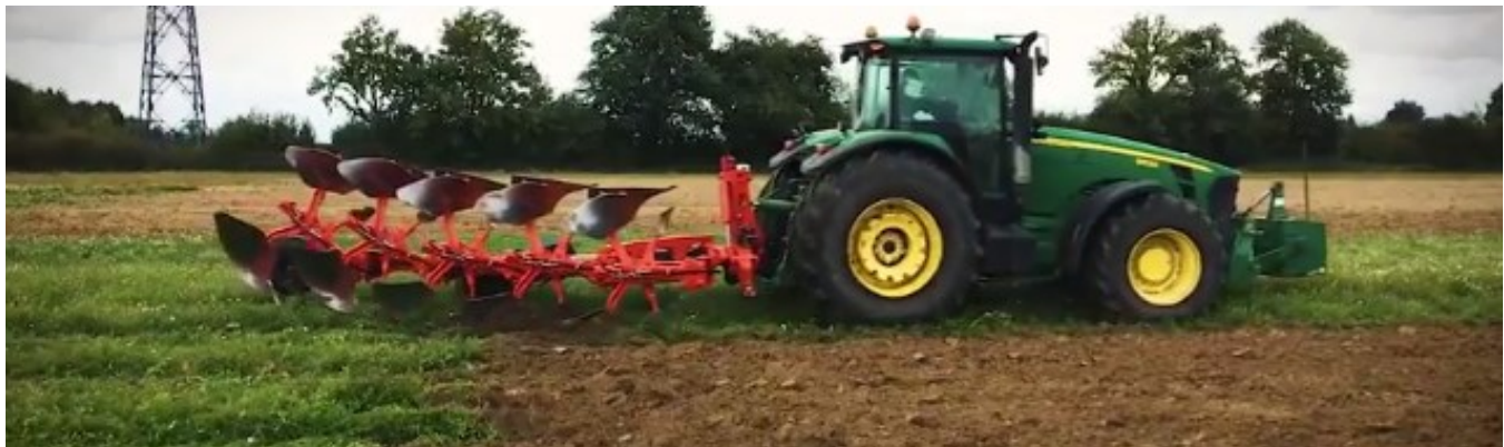
Kuhn Smart Ploughing : Charrue aux multiples sections pilotées par GPS
