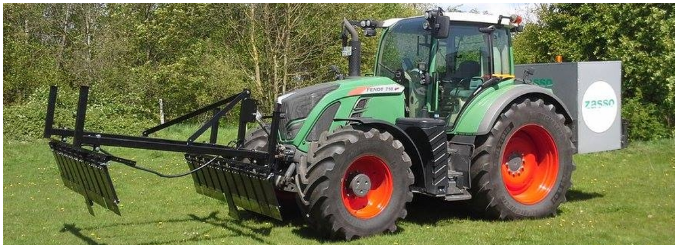
Electroherb : le courant passe ici entre les 2 rangés d'électrodes
