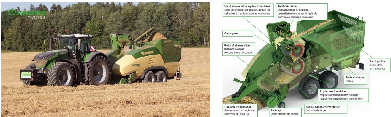
Krone Premos 5000 en action et schéma de fonctionnement
