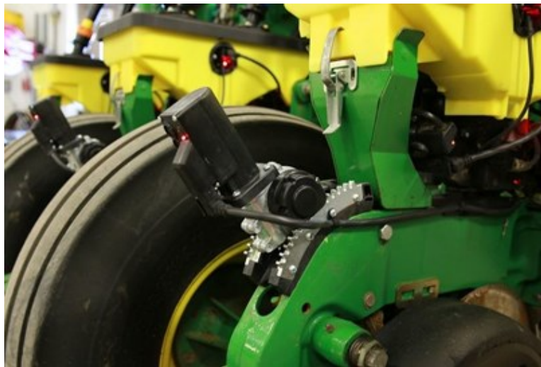
Distribution électrique du semis développé par Precision Planting © grostracteurspassion
