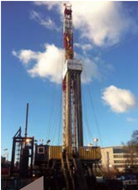
Rig de forage géothermique en France.
